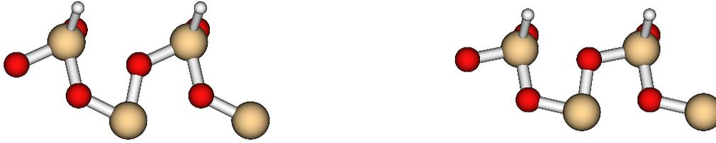
FIG. 5.29: *Vue synthétique des optima semi-empirique et DFT du modèle d'interface Si(100)/SiO<sub>2</sub>.*
