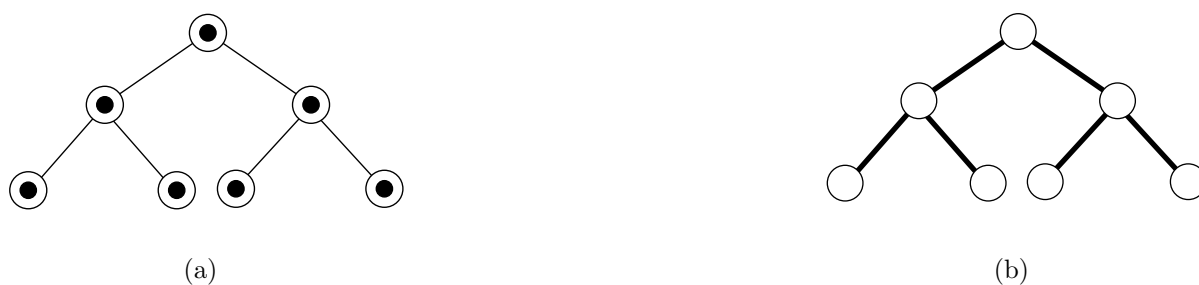
FIG. 1.4 – Dans un algorithme de colonie de fourmis, les pistes de phéromone peuvent être associées aux composants (a) ou aux connexions (b) du graphe représentant le problème à résoudre.
