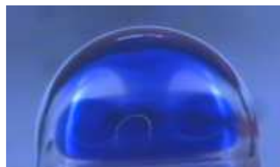
Figure 12 : fusion d'une goutte de bleu trypan et d'une goutte d'eau de 5 \mu l, 40ms après contact. Des mouvements de convection du colorant apparaissent. (Travaux effectués avec Olivier FUCHS (CEA/LETI), 'Microdroplets coalescence using electrical forces' au colloque d'hydrotechnique/172/2002-12-03/Toulouse FRA)
