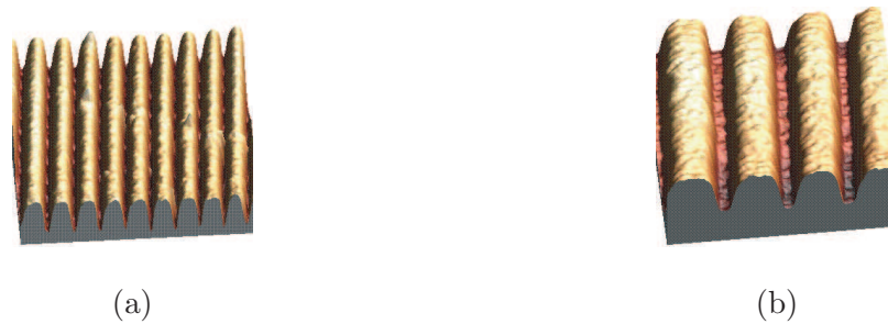
Figure 5.19 — Image AFM d'un réseau d'une période de 1 \mu m , le champ observé est de 10 \mu m \times 10 \mu m (a) et de 4 \mu m \times 4 \mu m (b). La profondeur de gravure est d'environ 20 \text{ nm} .
