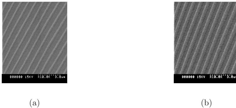
Figure 5.14 — Illustration de l'influence du temps d'exposition sur le rapport cyclique d'un réseau de 1 \mu\text{m} (grandissement \times 10000 ), 210 s (a) et 180 s (b).
