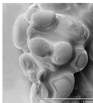
FIG. 4.12: La vue au microscope électronique d'un agglomérat de grains de neige liés par des ponts de glace.
