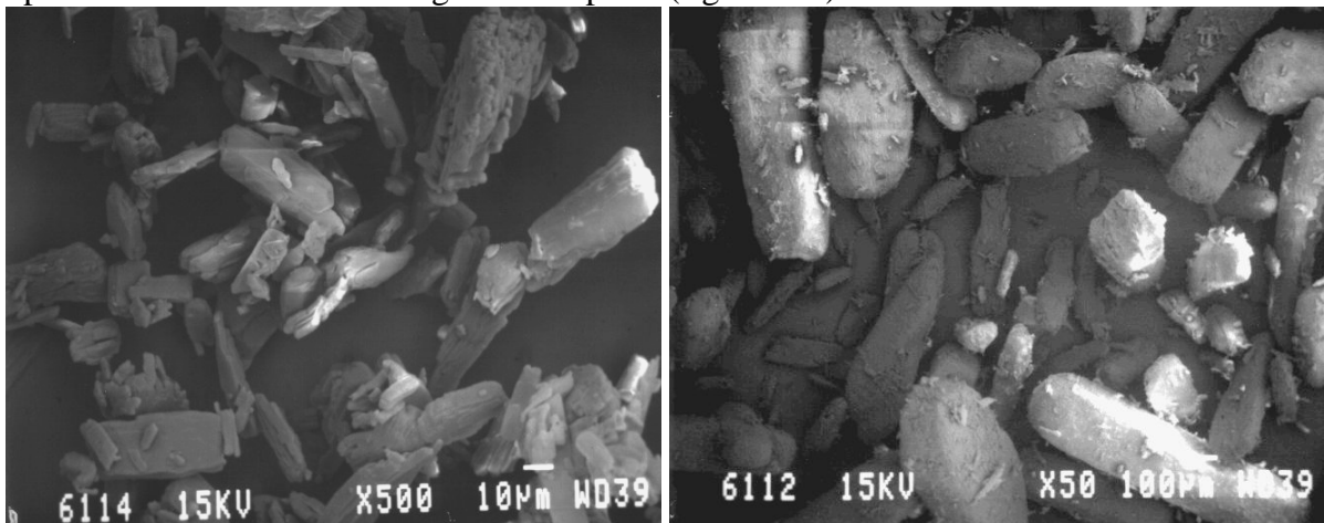
figure A.3 : photographies à microscopie à balayage des aspirines AC 180 (à gauche) et AC 360 (à droite)
