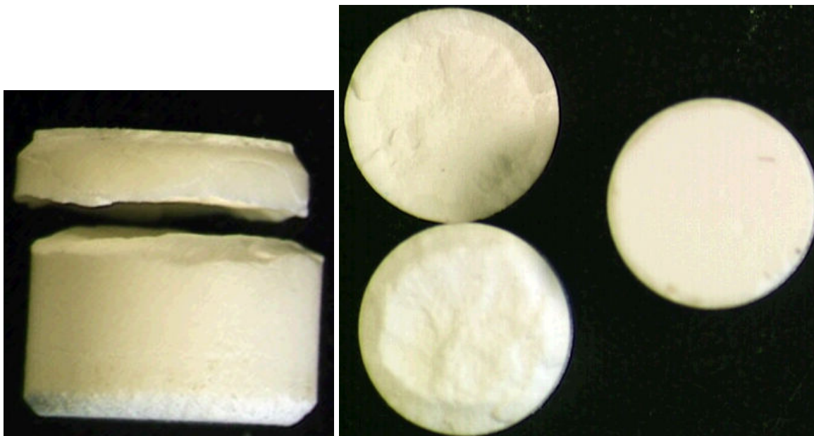
figure A.43 : comprimé d'amidon avec un clivage
