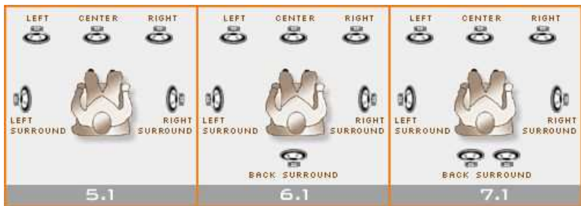
FIG. I.17 – Différents systèmes de restitution basés sur la technique Dolby Digital .
