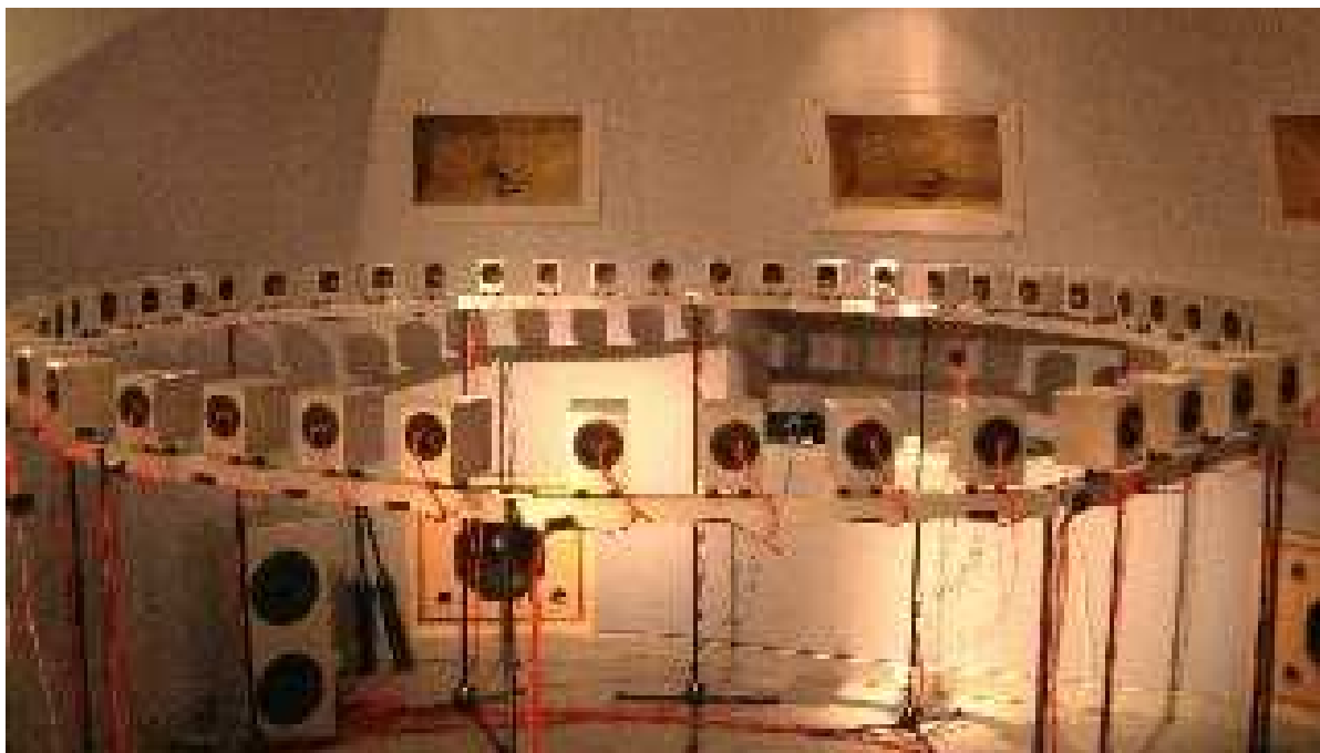
FIG. I.21 – Réseau de 48 hauts-parleurs pour une restitution holophonique.
