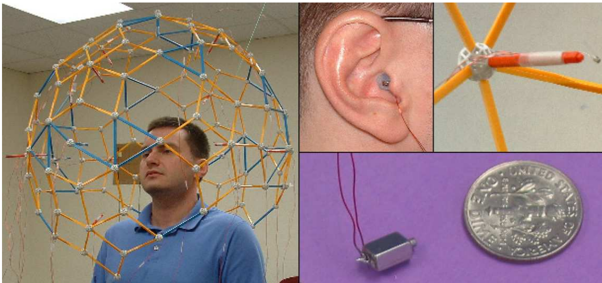
FIG. III.9 – Système de mesures réciproque de HRTF [Zotkin et al. (2004)].
