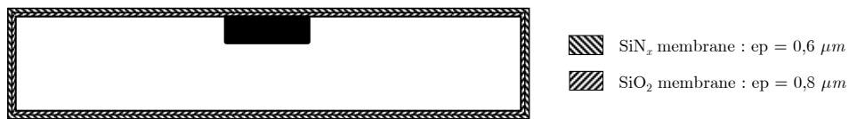
Figure 3.27 : Dépôt de la couche \text{SiO}_2/\text{SiN}_x .
