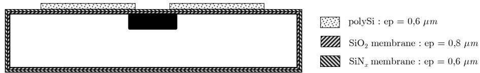
Figure 3.32 : Elimination du polySi les faces latérales et inférieure.
