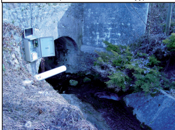
Photo n°III.3 : Station de mesure des hauteurs d'eau de la Fruitière – Bassin versant du Drainan
