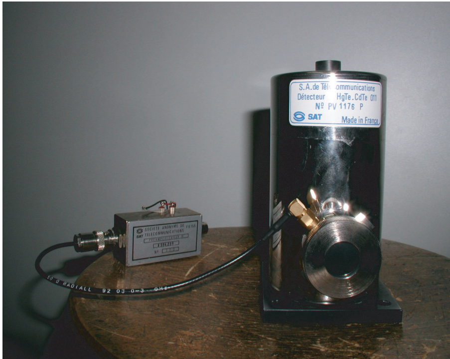
FIG. 2.6: Photo du détecteur HgCdTe avec son module d'amplification bas bruit.
