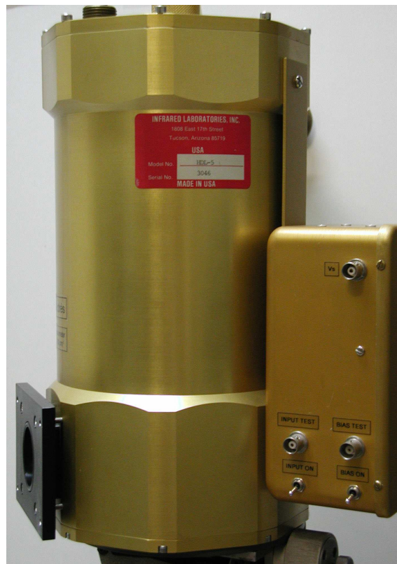
FIG. 2.7: Photo du bolomètre, hauteur du bolomètre=50cm.
