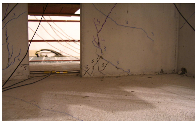
Figure 3.29- Maquette ECOLEADER : Mur Y après le test T5.
