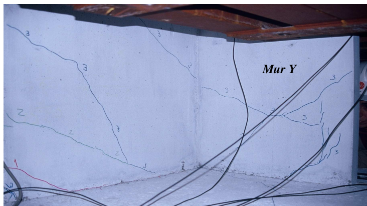
Figure 3.24- Maquette ECOLEADER : Mur Y après le test T3.
