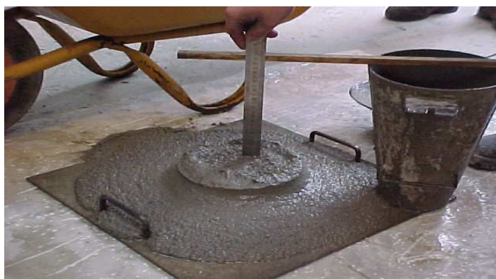
Figure 3.7- Maquette ECOLEADER : Test d'affaissement
