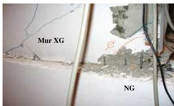
Figure 3.30- Maquette ECOLEADER : Mur XG après le test T6.
