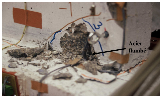
Figure 3.26- Maquette ECOLEADER : Mur XD après le test T3.
