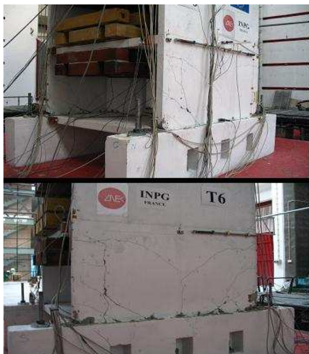
Figure 4.34- Maquette ECOLEADER : Etat de la maquette à la fin de l'essai (T6).
