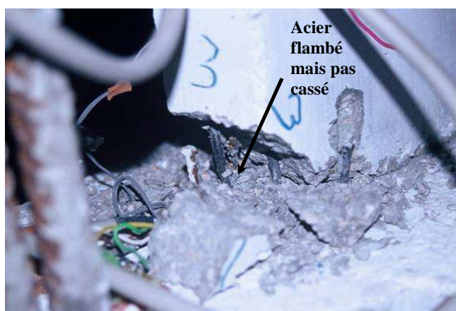
Figure 3.28- Maquette ECOLEADER : Mur XD après le test T5.
