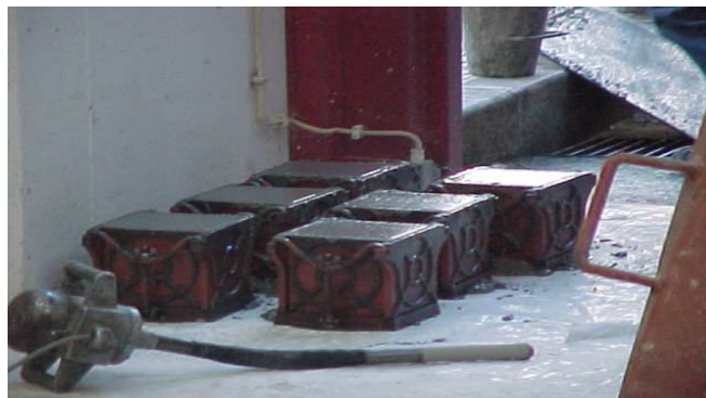
Figure 3.6- Maquette ECOLEADER : Les cubes de béton testés en compression
