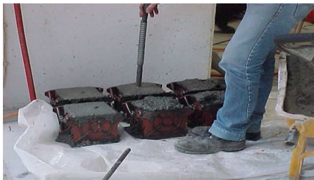
Figure 3.5- Maquette ECOLEADER : Vibration des cubes de béton
