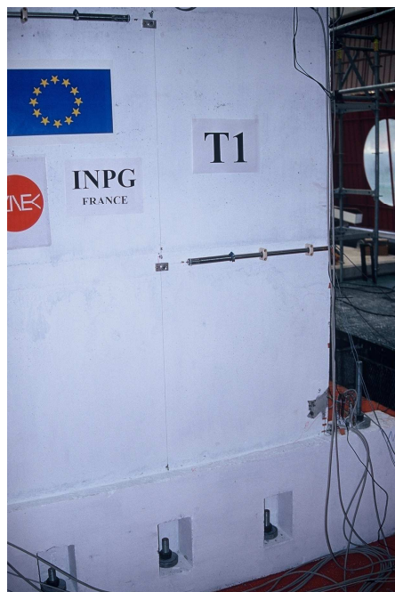
Figure 3.22- Maquette ECOLEADER : Mur XD après le test T1
