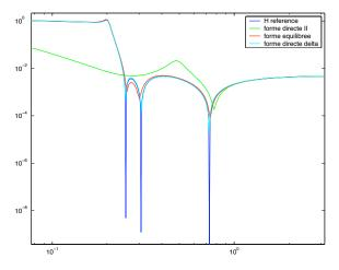
Diagramme de Bode avec coefficients virgule fixe sur 11 bits
