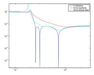
Diagramme de Bode avec coefficients virgule fixe sur 6 bits
