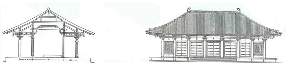
图 3-4 唐招提寺金堂复原侧面、正面断面图
