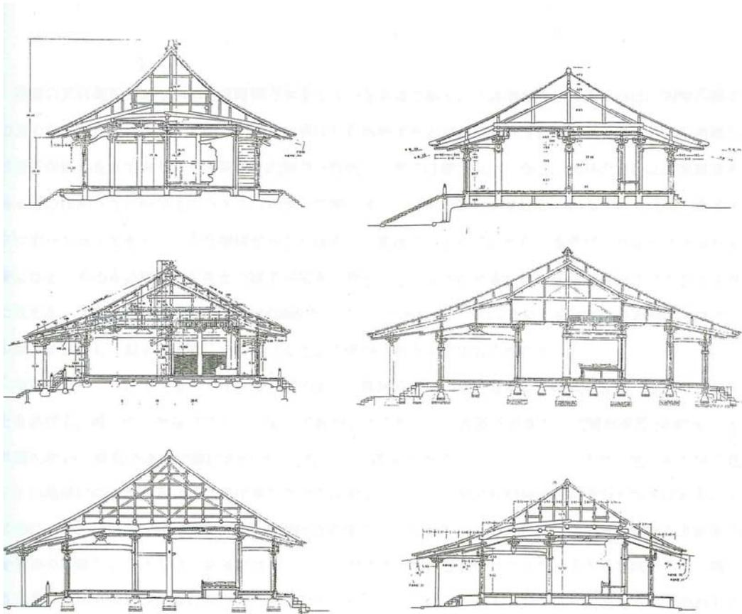
Figure 835 Coupes des temples avec le « Kondô » et le « Raidô » dont la hauteur des deux plafonds décalés,
