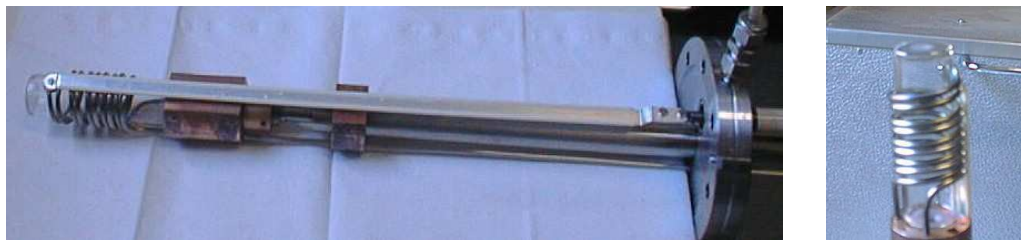
FIG. A.2 – Source d’oxygène du laboratoire. A gauche: ensemble de la source. A droite, détail de la cavité radiofréquence en quartz, au sommet de laquelle on distingue le trou d’effusion.
