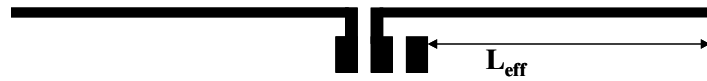
Figure.III.24 : Schéma équivalent de la différence de longueur de l'antenne entre ses bras et les plots d'accès.
