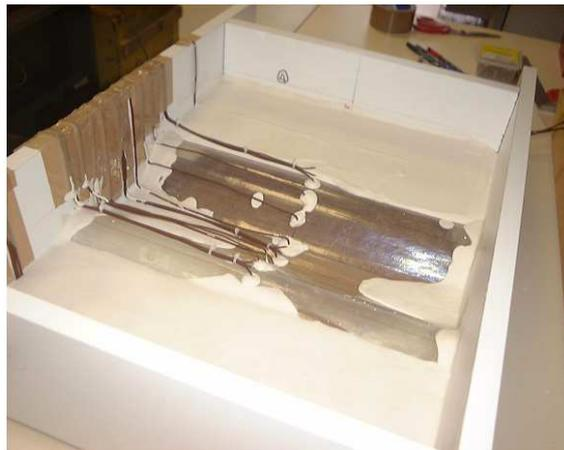
FIG. F.4 – Deuxième phase du moulage de la maquette
