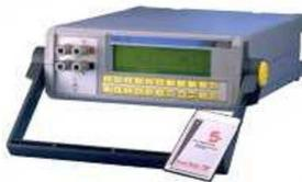
FIG. G.1 – Station d'acquisition des températures SA32
