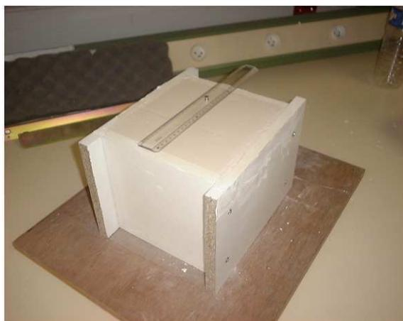
FIG. 4.21 – Cube de plâtre, de 20 cm d’arête, dans son moule, avant démoulage
