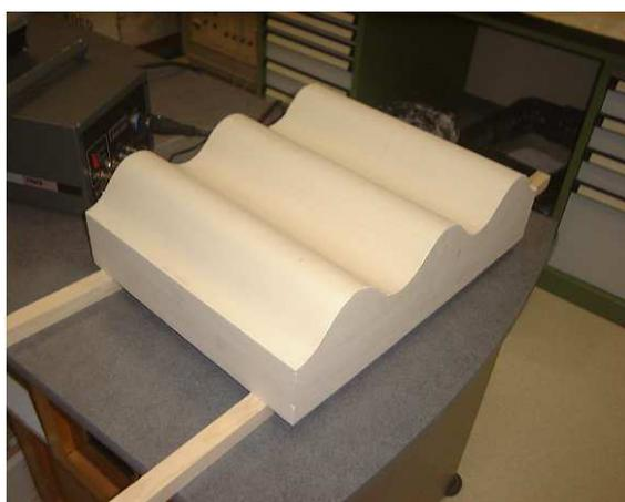
FIG. F.6 – Maquette finale instrumentée et démoulée
