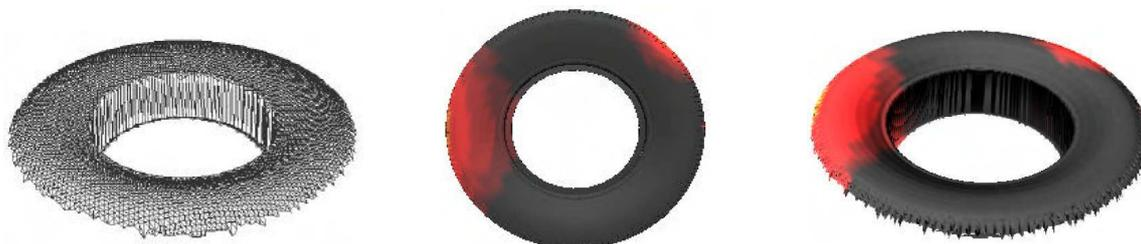
FIG. C.1 – Extraits des travaux de Gray et al. : maillage 3D du pneu, image infrarouge du pneu, puis obtention d'une texture thermique par placage de l'image infrarouge sur le maillage 3D
