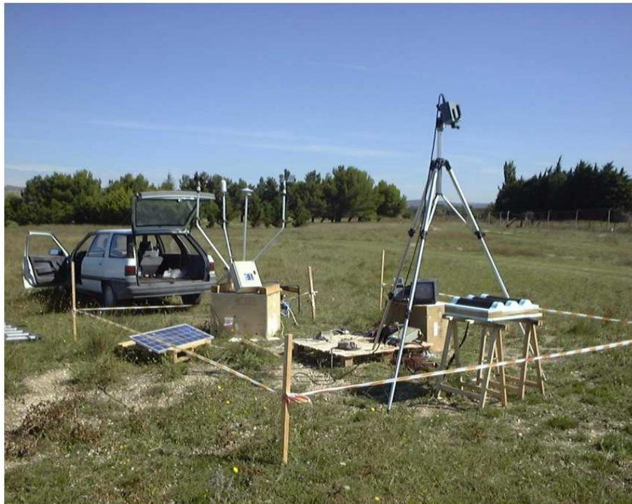
FIG. 4.29 – Dispositif de mesure. Tous les instruments (panneau solaire, station météorologique, caméra infrarouge, station d’acquisition, batterie) sont placés au nord de la maquette, afin de ne pas créer d’ombrage
