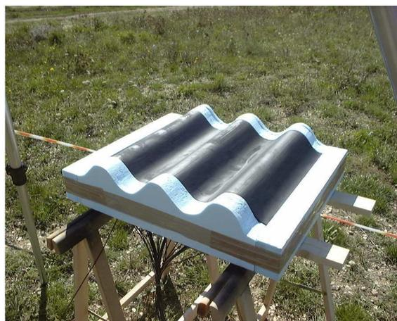
FIG. 4.26 – Maquette finale peinte et isolée, et placée en extérieur pour les mesures
