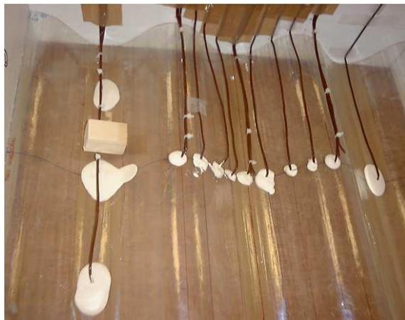
FIG. F.3 – Thermocouples de surface fixés, dans le moule de la maquette définitive, avec une petite quantité de plâtre presque pris
