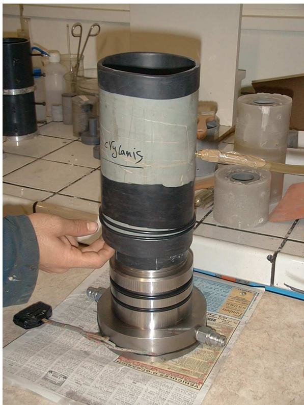
Figure VI.9 : Etape de préparation pendant placer la membrane autour de l'échantillon
