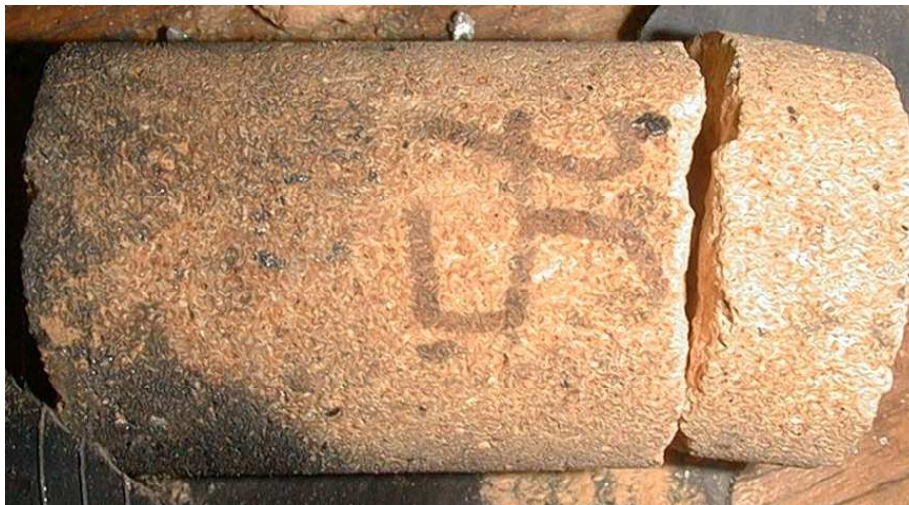
Figure 3.13 : Mode de rupture (échantillon Tri5)
