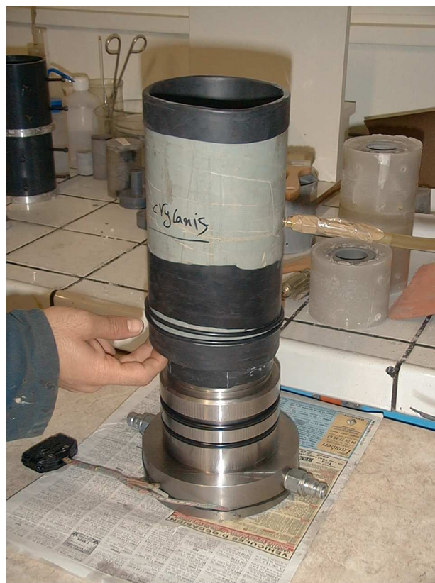
Figure VI.2 : Etape de préparation pendant placer la membrane autour de l'échantillon
