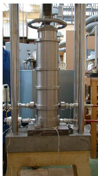
Figure VI.4 : Etape de préparation après avoir installé tous les instruments
