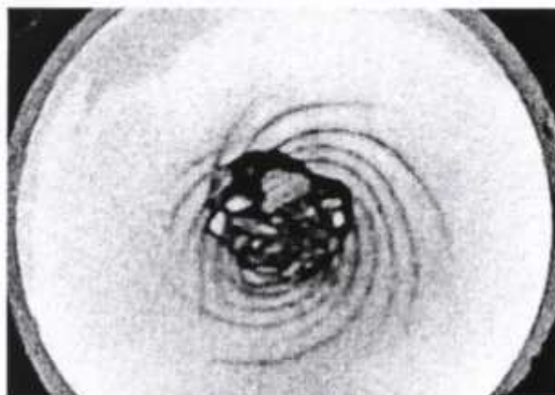
Figure 2.41 : La rupture par de cisaillement en forme de spirale (E. Papamichos et al., 2004) [30]
