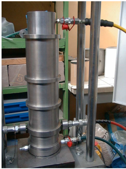
Figure VI.13 : Etape de préparation après avoir Connecté les flexibles de la sortie de générateur et de pompe à cellule par coupleur rapide
