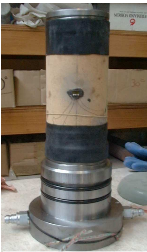
Figure VI.1 : Etape de préparation après avoir placé deux rubans de membrane
