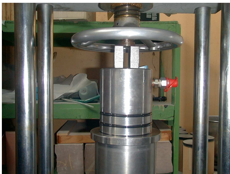
Figure VI.12 : Etape de préparation pendant pénétrer le piston dans le corps de cellule grâce à la presse
