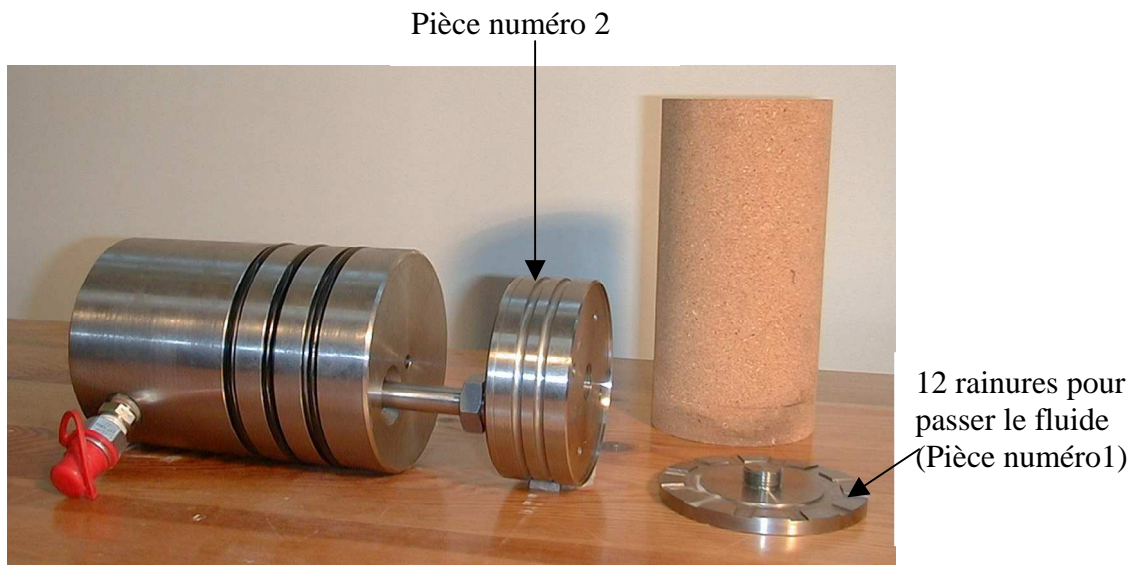
Figure 4.10 : Nouvelles pièces usinées et l'échantillon cylindrique creux
