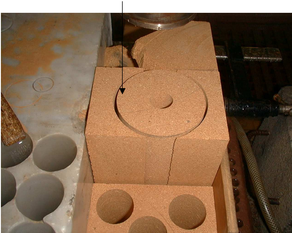
Figure 3.3 :Echantillon après carottage
