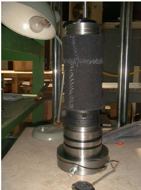
Figure VI.7 : Etape de préparation après avoir placé le Scotch brite autour de l'échantillon
