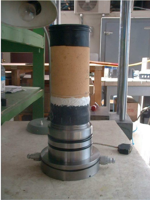
Figure VI.5 : Etape de préparation après avoir placé deux rubans de membrane
