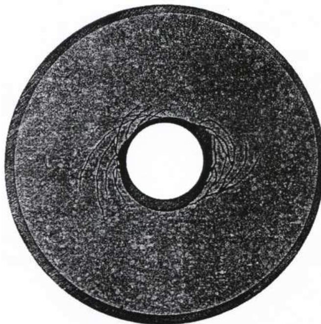
Figure 2.23 : Mode de rupture d'un échantillon cylindrique creux [8]
