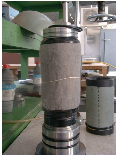
Figure VI.8 : Etape de préparation après avoir placé le géotextile autour de l'échantillon
