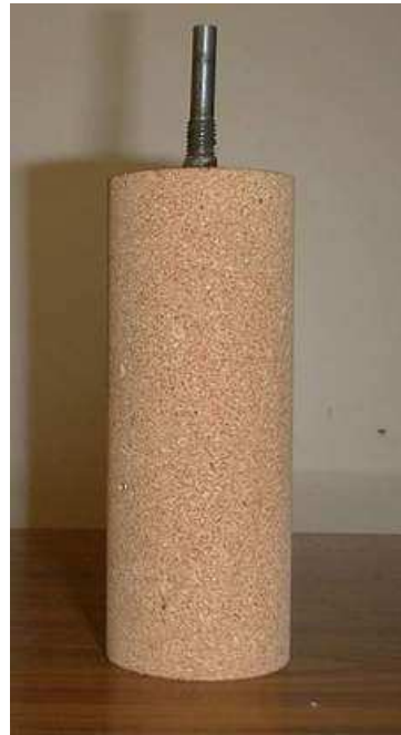
Figure 3.15 : Echantillon d'essais de perméabilité
