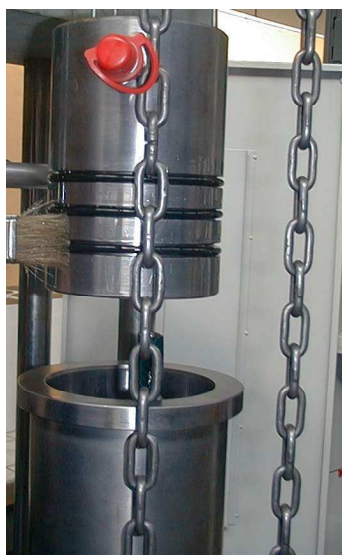
Figure VI.11 : Etape de préparation pendant placer le piston sur le corps de cellule
