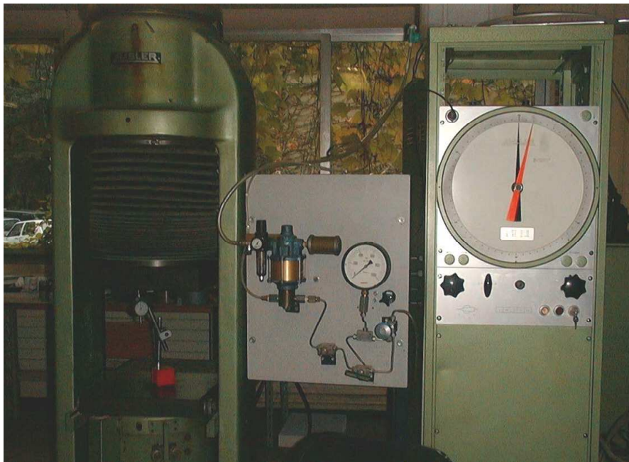
Figure 3.11 : Presse AMSLER (Capacité 3000 kN)
