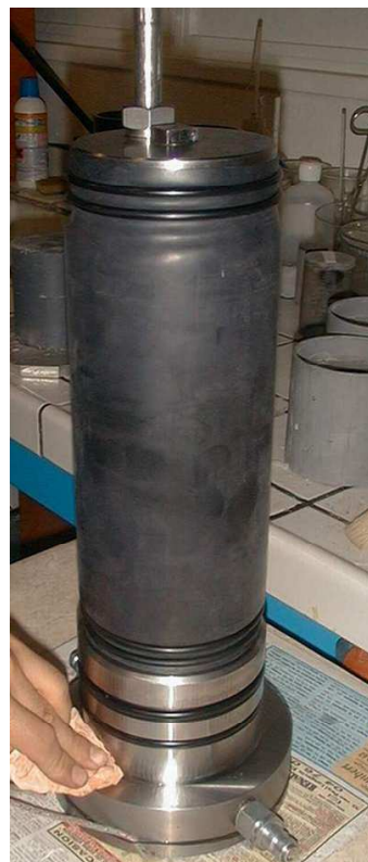
Figure VI.10 : Etape de préparation après avoir placé la membrane avec les o-rings
