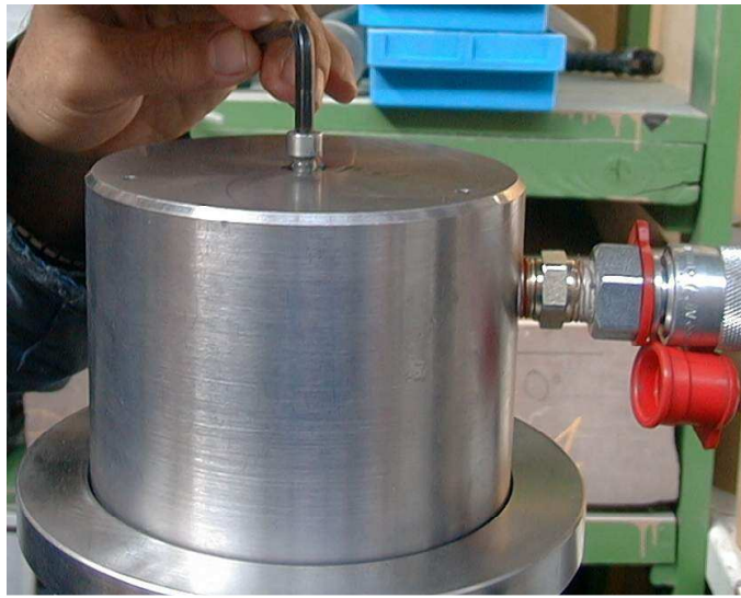
Figure VI.14 : Etape de préparation pendant fermer la vis de purge
