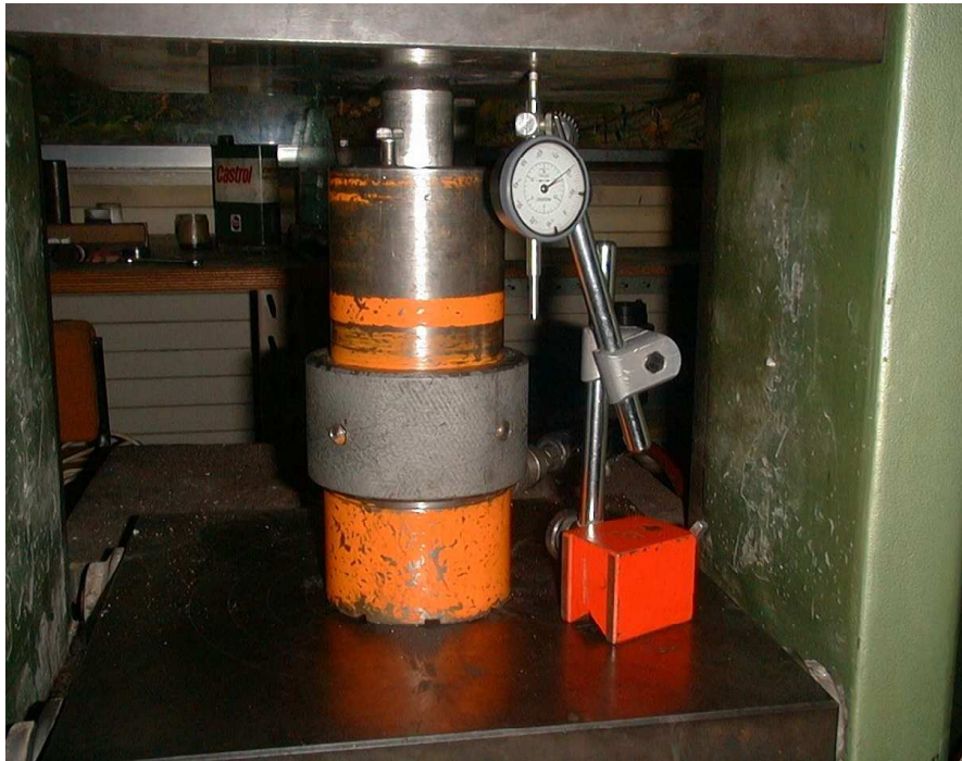
Figure 3.12 : Cellule triaxiale sous la presse (Capacité de la cellule 60 MPa)
