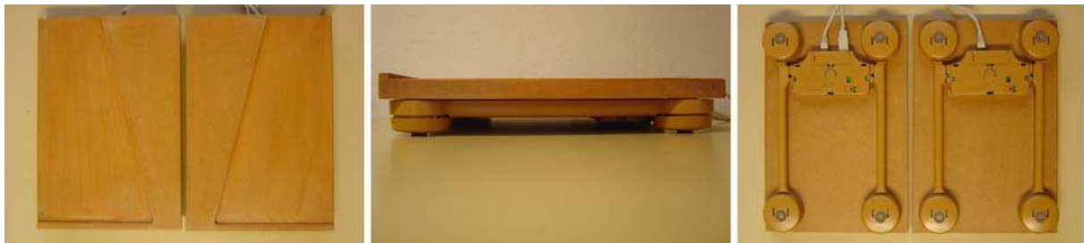
Figure 13 : Double plate-forme de force utilisée dans le cadre de ce travail de thèse : Vue de dessus, Vue de profil, Vue de dessous.
