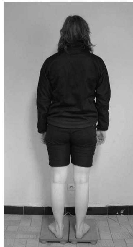
Figure 14 : Exemple de sujet sain installé debout sur une double plate-forme de force.
