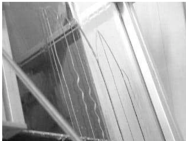
Figure III-38 : Méandres d'huile silicone 5 cP sur une plaque de verre enduite du fluoropolymère FC725. Les filets sont ici formés par rupture d'un film continu dont ils captent le liquide. Inclinaison \alpha=70^\circ et débit Q=11,8 mL/s. Vue de trois quarts. Photographie Julien SEBILLEAU.
