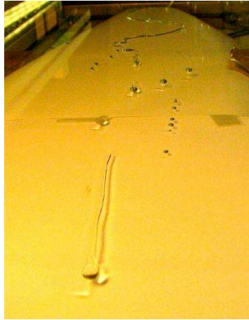
Figure II-23 : Goutte d'eau « spermatozoïde » dévalant un plan incliné en Plexiglas recouvert d'un film protecteur commercial de composition non communiquée.
