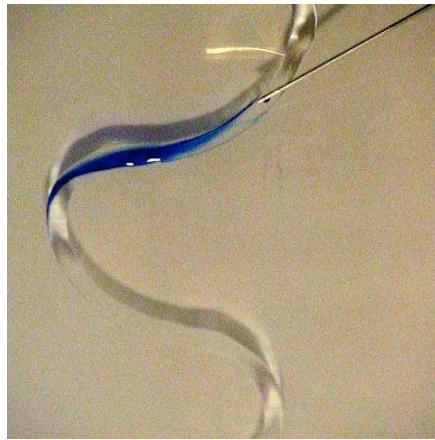
Figure III-37 : Gradients de vitesse au sein des méandres révélés par injection de bleu de méthylène. Le colorant n'avance pas en front perpendiculaire au méandre, mais il se déplace beaucoup plus rapidement sur l'extérieur des virages que sur l'intérieur.
