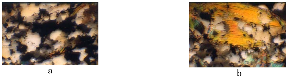
Figure 1-66. Lames minces observées au microscope en lumière analysée (grossissement \times 5,6 ) sur des phtanites prélevés dans la carrière de Brandefert désaffectée. Des cristaux de muscovite (plus gros en b) sont observés au sein d'une matrice graphitique (quartz et matière organique)
