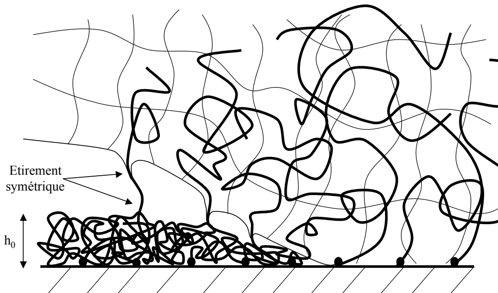
FIG. 4.10 – Déformation de la surface de l'élastomère lors de l'extraction des chaînes.
