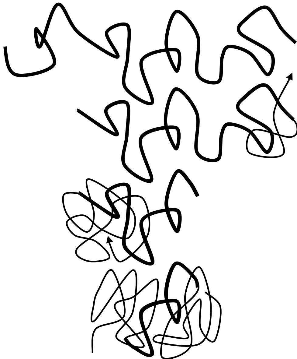
FIG. 8.4 – Relaxation d'une chaîne étirée : les extrémités du tube dans lequel la chaîne est confinée sont progressivement défaites lors de la reptation vers la droite puis vers la gauche, tandis que des sections de tube sans orientation privilégiée sont reformées.
