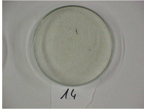
FIG. 15.2 – Sphères de 130\ \mu\text{m} de diamètre recouverte d'une couche de Ta_2O_5 .
