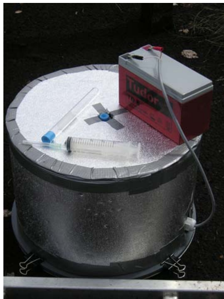
Figure 9-3 : (a) Vue d'ensemble du dispositif de mesure in situ des flux de méthane sur la station B (régénération récente) et (b) chambre de mesure du méthane avec seringue, tube de prélèvement et batterie pour le ventilateur sur la station A (tourbe nue).
