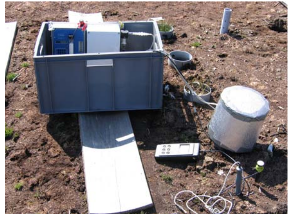
Figure 9-6 : (a) Vue d'ensemble d'une creuse avec la mesure des échanges nets de \text{CO}_2 à lumière saturante et (b) vue du dispositif de mesure des flux de \text{CO}_2 (respiration à l'obscurité) sur un pot.
