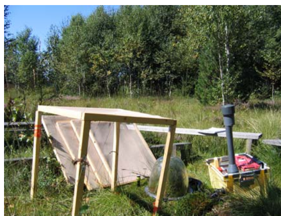
Figure 9-2 : Vue d'ensemble des mesures de \text{CO}_2 in situ sur la station C (régénération avancée) avec l'analyseur de gaz infra-rouge (CIRAS1) (a) des échanges nets de \text{CO}_2 de l'écosystème à lumière saturante ( \text{PPFD} > 500 \mu\text{mol m}^{-2} \text{s}^{-1} , \text{EE}_{\text{Nsat}} ) ; (b) à l'obscurité, de la respiration de l'écosystème ( \text{R}_E ), (c) des échanges nets de \text{CO}_2 de l'écosystème à lumière non saturante avec l'ombrage artificiel avec le dispositif des cadres grilles ( \text{PPFD} < 500 \mu\text{mol m}^{-2} \text{s}^{-1} , \text{EE}_N ).
