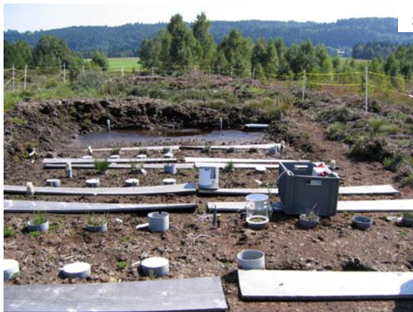
Figure 9-6 : (a) Vue d'ensemble d'une creuse avec la mesure des échanges nets de \text{CO}_2 à lumière saturante et (b) vue du dispositif de mesure des flux de \text{CO}_2 (respiration à l'obscurité) sur un pot.
