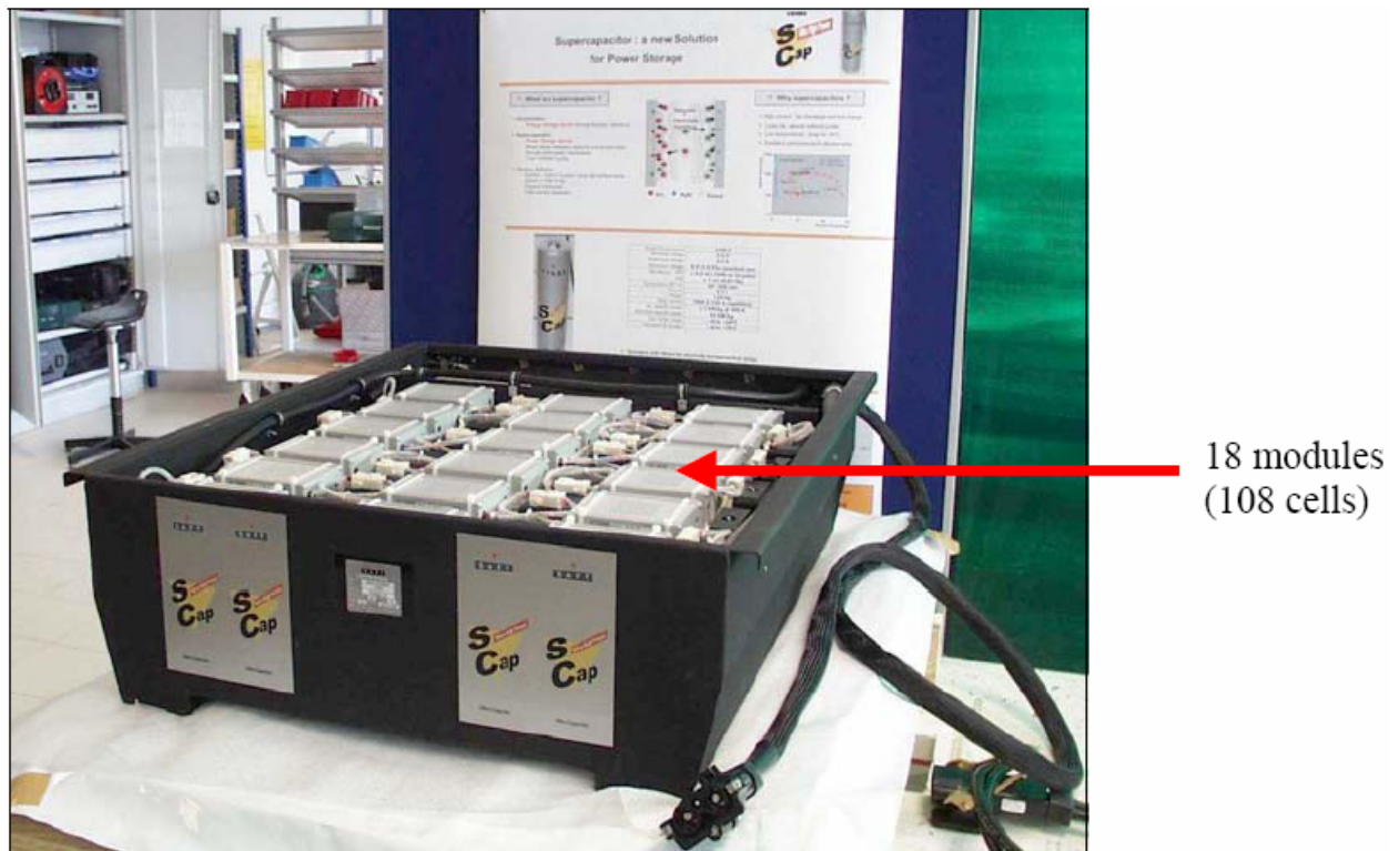
Figure 2.37 : Module supercapacitif Saft 34 F - 270 V [Des03].
