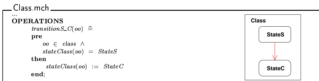
Figure 3.6 – Dérivation d'une transition
