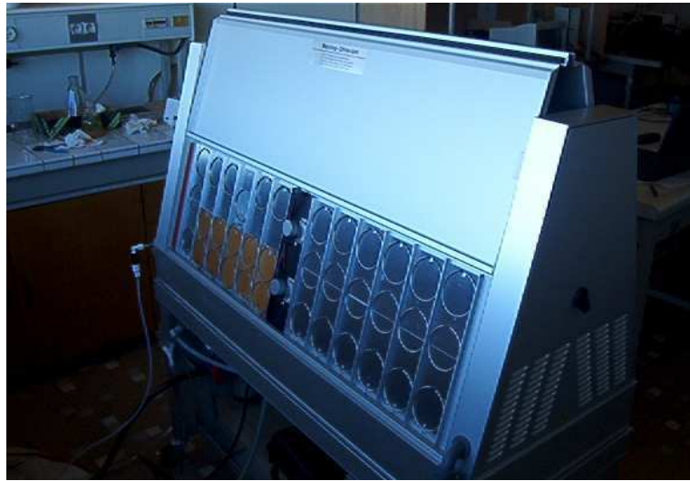
FIG. 2.4 – Appareil de vieillissement au QUV
