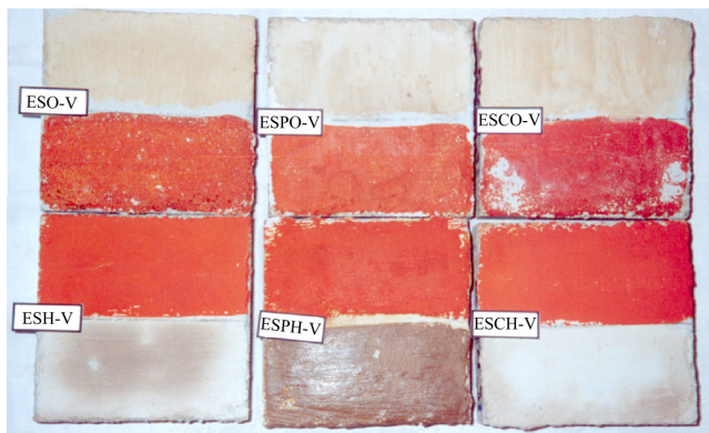
Figure III-35: Vue globale de la surface des éprouvettes à l'œuf (ESO-V, ESPO-V, ESCO-V) et à l'huile (ESH-V, ESPH-V et ESCH-V) après le test T9.
