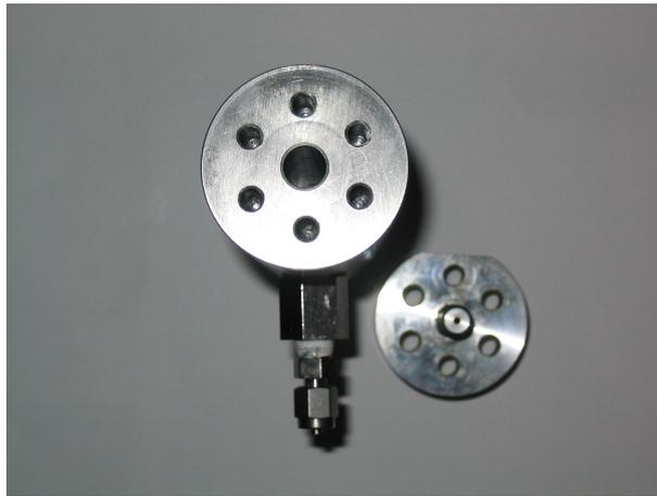
FIG. 6.2 – Cellule utilisée pour étudier les effets inertiels.
