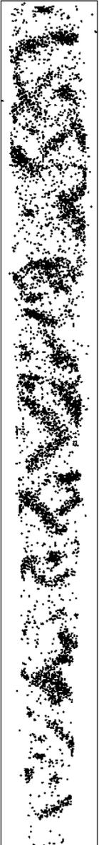
FIG. 6.3 – Zoom sur une aiguille analysée dans un échantillon revenu 2h à  $185^\circ\text{C}$  sans prérevenu. On a représenté les atomes d'Al (bleu), de Mg (magenta), Si (vert) et Cu (rouge). L'aiguille est bien orientée à  $45^\circ$  des plans (220) de la matrice (distants de 0,14 nm), comme attendu pour une direction [001].
