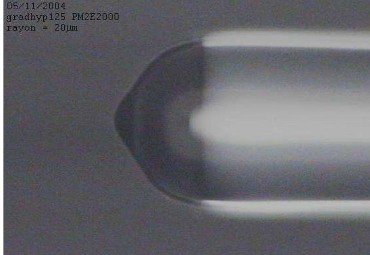
FIG. B.14 – Photographie d'une fibre micro-lentillée fabriqué au cours de ce travail.
