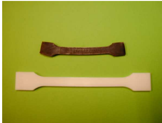
FIG. 6.20 – Éprouvette de Delrin 100 ST non vieillie, comparée à une éprouvette vieillie 5 036 h à 130°C, correspondant à plus de 50% de perte de masse
