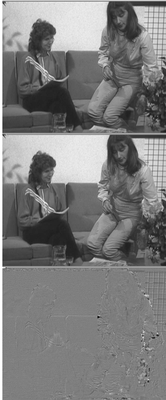
FIG. 1.2 – Séquence «Interview», image 19. Modélisation du mouvement par blocs ( 16 \times 16 pixels, mouvement de translation). Image originale, image compensée en mouvement, image d'erreur. L'image d'erreur est amplifiée d'un facteur 2 et recentrée autour du niveau de gris 128. L'erreur la plus visible est à l'intersection de l'épaule et des carreaux, où une ligne horizontale a été dupliquée.
