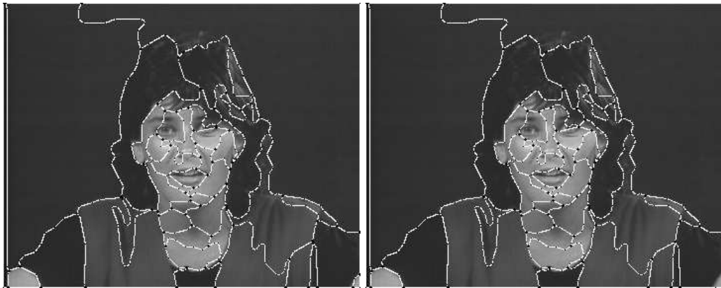
FIG. 2.16 – Fusion des points multiples. À gauche est montrée la segmentation avant fusion et à droite le résultat de la fusion, après élimination des petites régions.
