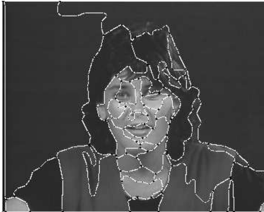
FIG. 2.15 – Résultat de l'approximation polygonale. Nous autorisons une erreur d'approximation d'une surface de 0,3 pixels carré par élément de contour de la chaîne initiale.
