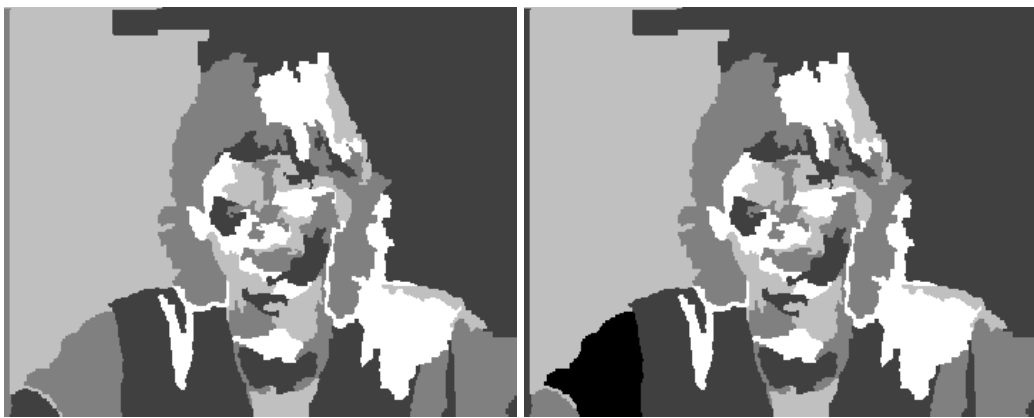
FIG. 2.11 – Résultat du filtrage par bloc. À gauche est montré le résultat du filtrage et à droite le résultat de l'élimination des petites régions. Ici la taille minimale d'une région est de 70 pixels.
