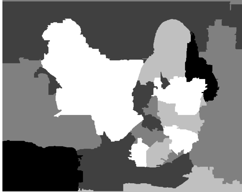
FIG. 2.23 – Résultat du filtrage par bloc. Ici la taille minimale d'une région est de 110 pixels.
