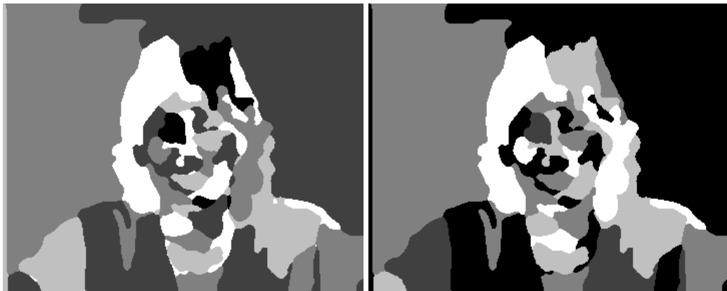
FIG. 2.12 – Résultat du filtrage majoritaire. À gauche est montré le résultat du filtrage et à droite le résultat de l'élimination des petites régions. La taille du filtre majoritaire est 9 \times 9 pixels et la taille minimale d'une région est de 70 pixels.
