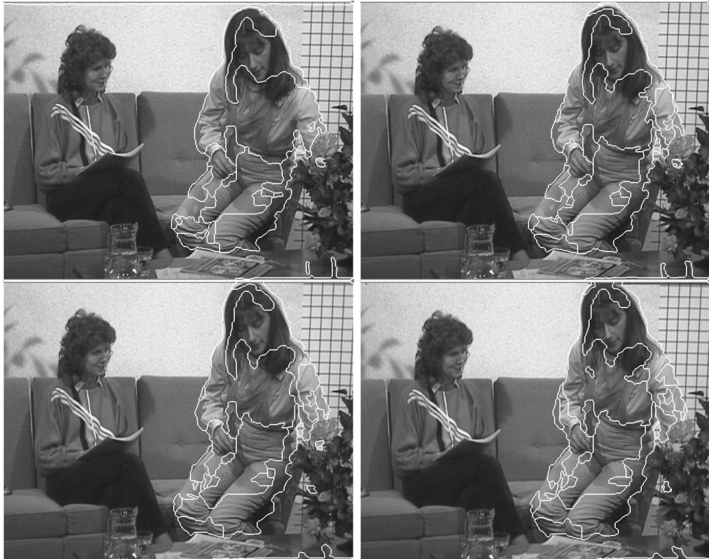
FIG. 1.5 – Séquence «Interview», images 11, 12, 14 et 15. Représentation du mouvement par cartes d'étiquettes. Segmentation basée mouvement obtenue par une technique markovienne [Odobez 94].
