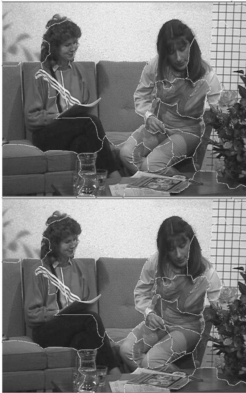
FIG. 3.25 – Ajustement des frontières, séquence «Interview», image 2. Dans l'ordre, ajustement affine et ajustement local.
