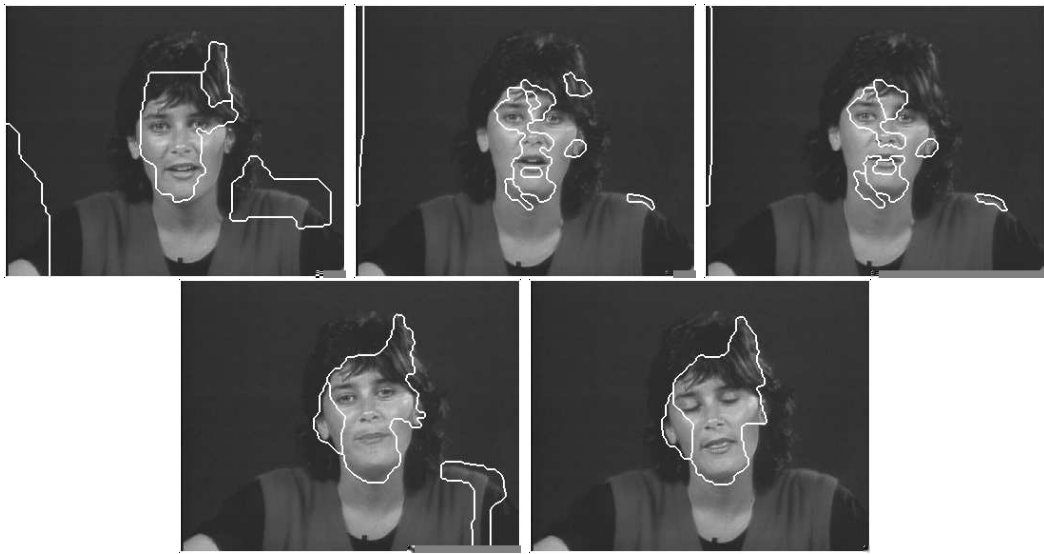
FIG. 1.4 – Séquence «Miss America», images 1, 32, 33, 56 et 62. Représentation du mouvement par carte d'étiquettes. Segmentation basée mouvement obtenue par une technique markovienne [Odobez 94].
