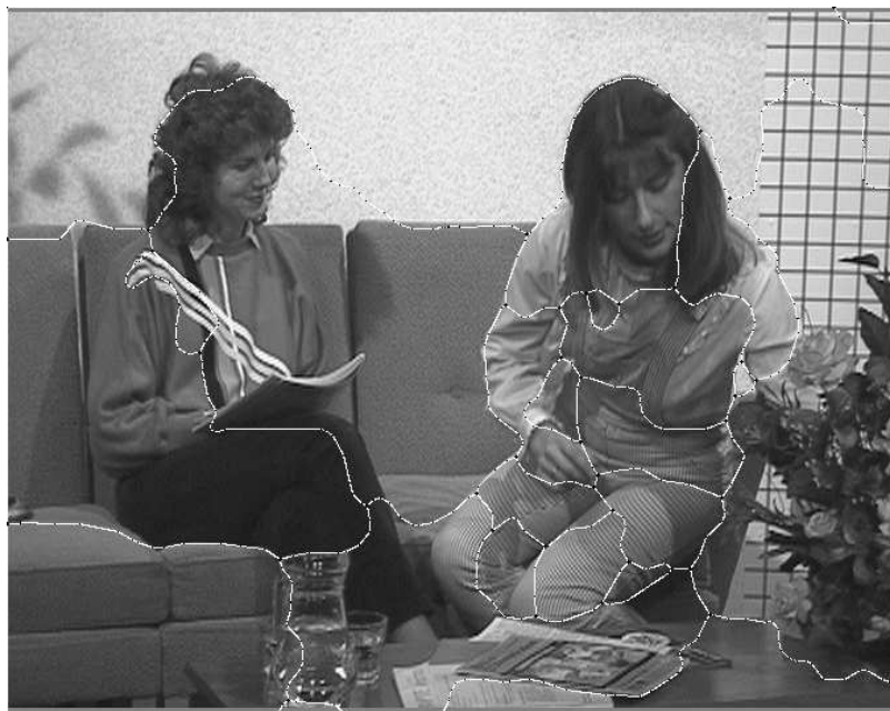
FIG. 2.26 – Résultat de l'approximation polygonale. Nous autorisons une erreur d'approximation d'une surface de 0,3 pixels carré par élément de contour de la chaîne initiale.
