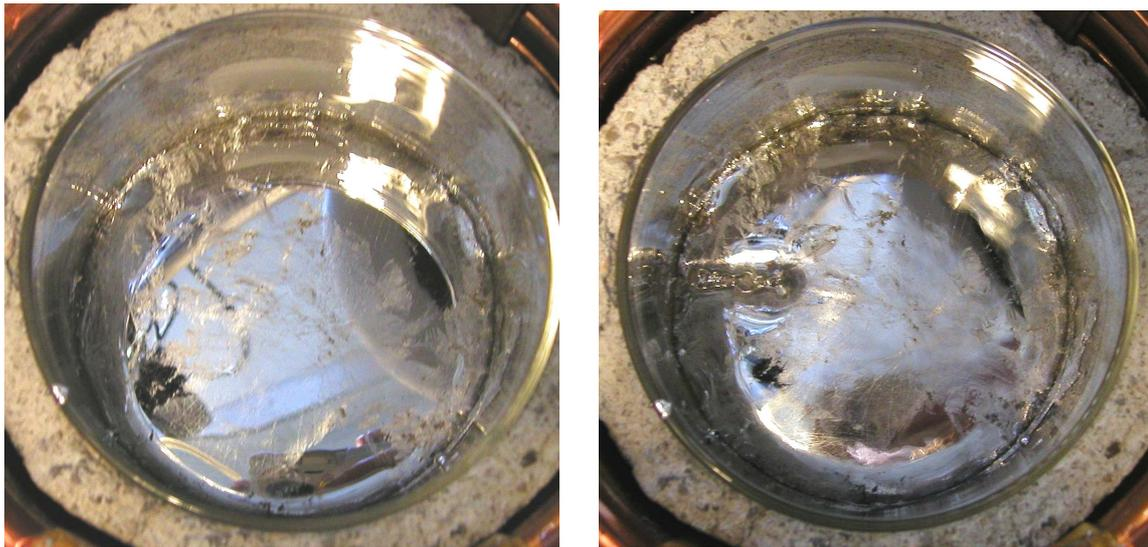
**Figure 1 : Dôme et ouverture du dôme au-delà d'un courant seuil**
