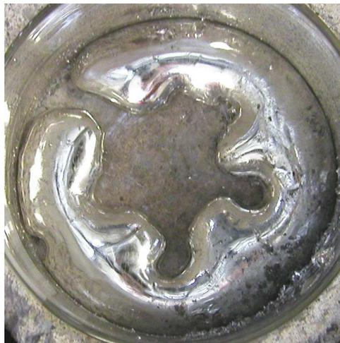
Figure 11 : Forme stable de la nappe à  $120 \text{ A}_{\text{eff}}$
