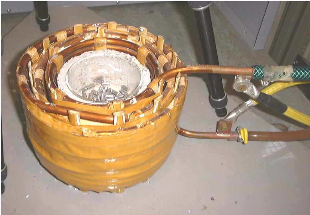
**Figure 5 : Inducteur utilisé dans l'expérience**
