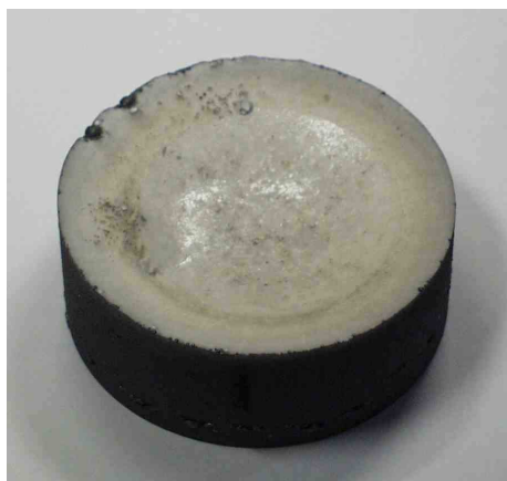
Figure 4.17 : Photo du lingot salin final de l'alliage \text{LiF-PbF}_2 ou \text{LiF-CeF}_3
