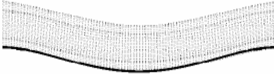
FIG. 4.6 – Déformation d'un nanotube de carbone double parois (diamètre 1,96 nm, longueur 20 nm), encasté aux deux extrémités, et soumis à une force de 1,8 nN. Comparaison entre le calcul en dynamique moléculaire et le profil (trait noir épais) calculé par la théorie des poutres (mécanique des milieux continus). D'après [77].
