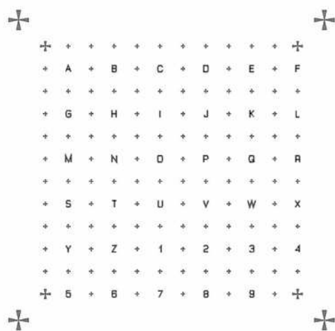
FIG. 3.3 – Masque de lithographie électronique pour dessiner les marques d'alignement. L'ensemble est composé de 105 petites croix, tout l'alphabet et les chiffres de 1 à 9. Notons aux quatre coins extérieurs de la grille de plus grandes croix qui serviront au réaligement des lithographies postérieures (avec une précision de 50 nm).
