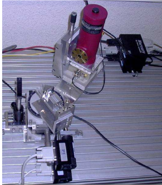
FIG. 4.9: Photographie du banc de m -lines dans l'infrarouge moyen. Dans cette illustration le détecteur est un monopixel refroidi placé sur un bras pivotant autour du prisme et permettant de détecter les franges noires à différentes positions angulaires ; Il a ensuite été remplacé par une caméra bolométrique infrarouge. L'échantillon et le prisme sont placés sur la platine de rotation motorisée. La focalisation du faisceau par la lentille placée avant le prisme sur le contact optique permet d'exciter les différents modes du guide planaire.
