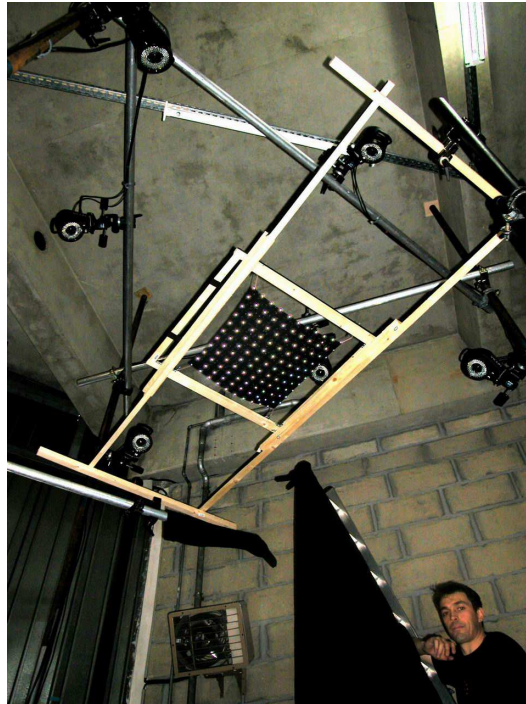
Figure 5.4 – Dispositif de lâchage à trois mètres du sol
