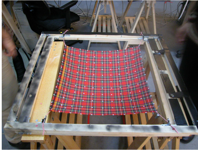
Figure 5.5 – Tissu avec les pastilles réfléchissantes maintenu au dispositif de lâchage
