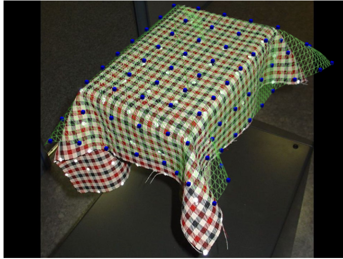
Figure 6.2 – Les points caractéristiques du tissu utilisés pour la calibration et la reconstruction (virtuels : cubes bleu et réels : pastilles blanches)
