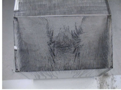
figure 1-12: Photographie des lignes de frottement sur la lunette arrière (Lienhart et Becker [48][49][50])
