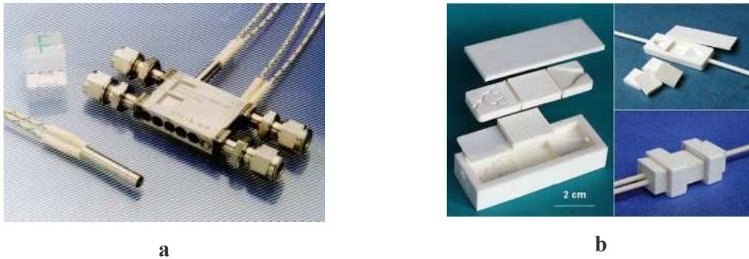
Figure B.22. a) Microréacteur pulsée en métal FZK [19] b) Microréacteur en céramique [18]
