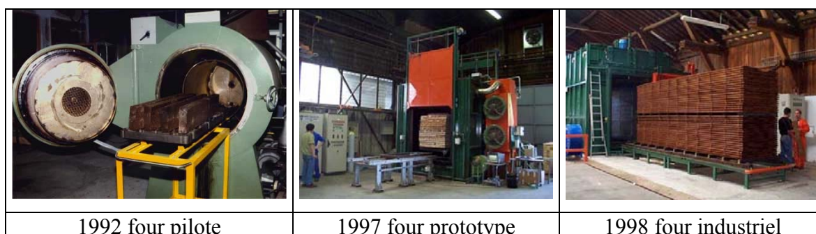
Figure 14. Les différentes étapes du développement des fours industriels.
