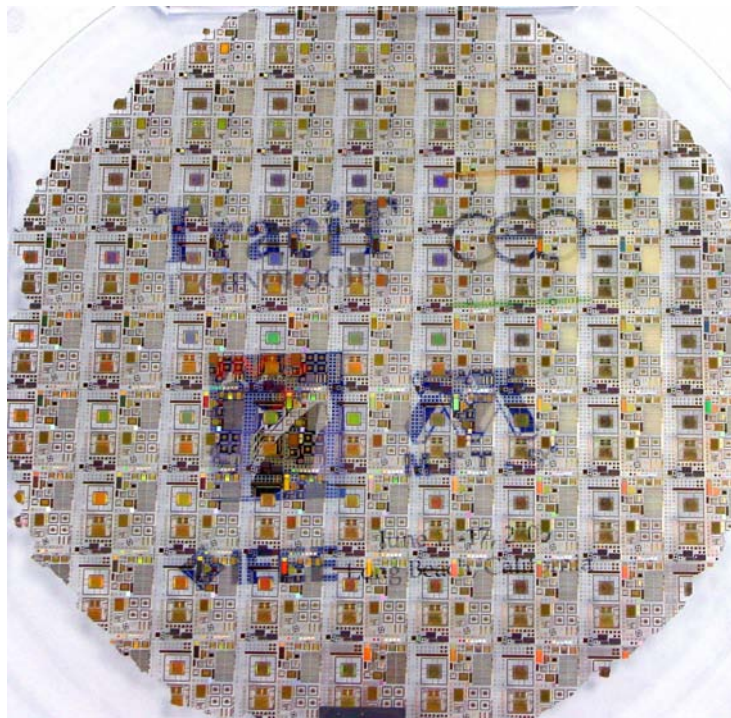
Figure I-3 : Circuits SOI transférés sur un substrat isolant de quartz (les objets sont visibles à cause de la transparence du substrat).
