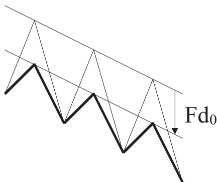
FIGURE 5.12 – Effet de la contrainte de force sur le niveau moyen de l'état de transition. En plus du gradient de potentiel qui définit un sens de migration préférentiel, la contrainte de force peut entraîner une variation du niveau moyen global de la barrière d'énergie à franchir au cours de la migration. On a fait le choix, a priori arbitraire, de représenter ici une baisse du niveau d'énergie de l'état de transition. Le paramètre d_0 est une distance caractéristique associée à l'effet de la contrainte de force.
