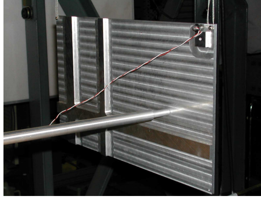
Fig. V.10 – Photographie de la plaque raidie (vue de derrière).
