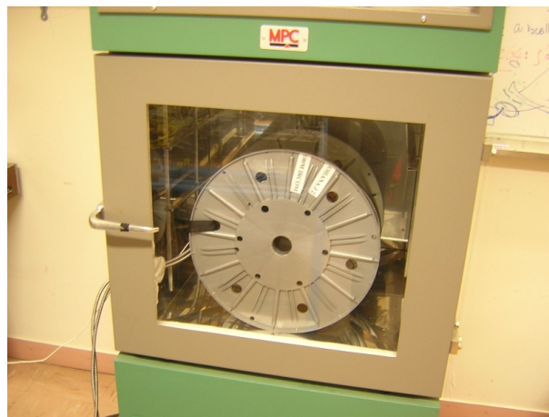
FIG. 5.1 – Photo de la bobine de fibre placée dans l'enceinte climatique
