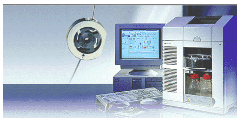
Figure III-13 Appareillage d'électrophorèse capillaire (Hewlett Parckard).
