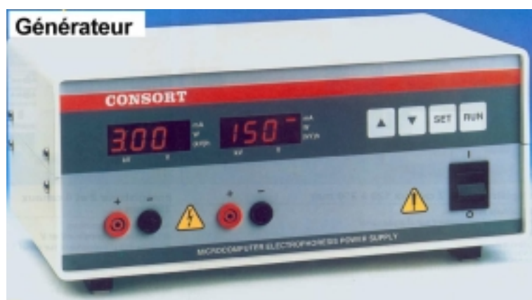
Figure III-14 Générateur de courant (Bioblock).
