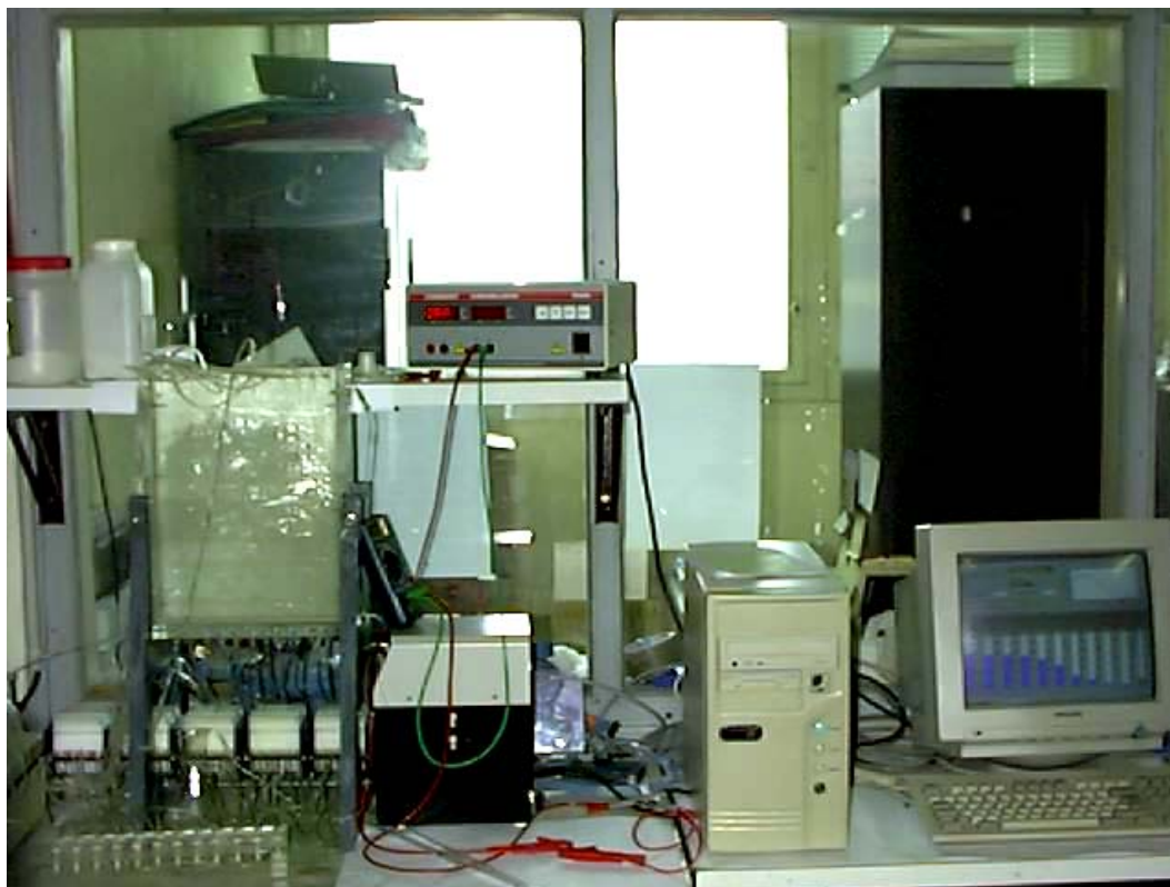
Figure VII-25 Dispositif expérimental pour l'étude de l'électrophorèse à focalisation dans une cellule verticale en écoulement.
