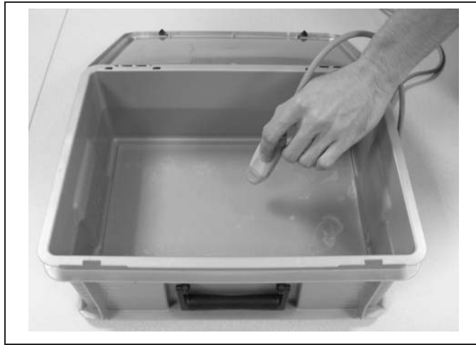
FIG. 1.12: Fantôme plan utilisé : il s'agit d'une plaque de plexiglass collée au fond d'un bac, l'air séparant la plaque du bac permet de diminuer les artefacts dans les images.
