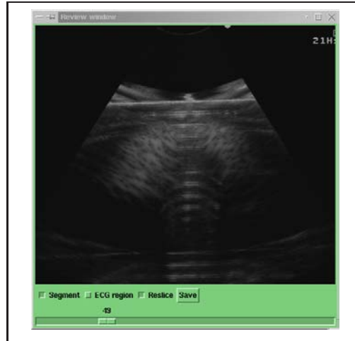
FIG. 2.18: Image échographique de la bille collée sur le fond du fantôme plan.
