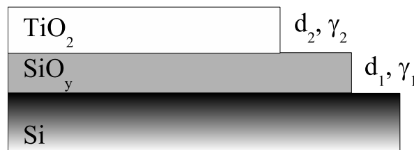
FIG. 4.11 – Structure modèle du système \text{TiO}_2/\text{SiO}_y/\text{Si} utilisée dans la détermination des épaisseurs d_i et des taux de recouvrement \gamma_i .
