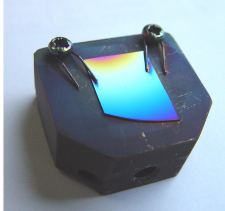
FIG. 3.7 – Photographie d'un dépôt de TiO_2/Si de plusieurs dizaines de nanomètres d'épaisseur ( d''_{200P1} ).
