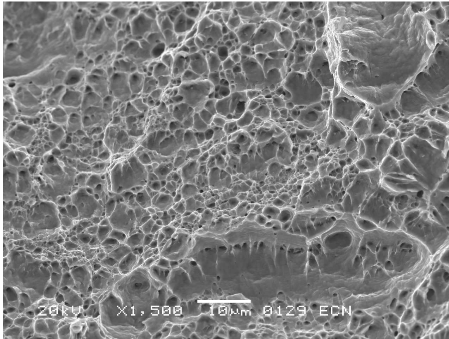
FIG. 4.21 – Faciès de rupture dans le métal de base
