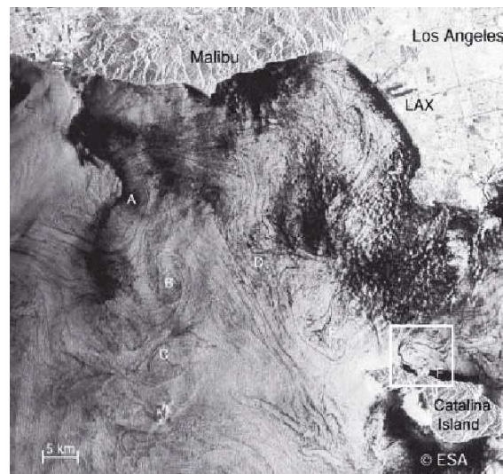
FIG. 1.16 – Petits tourbillons côtiers dans la Baie de Santa Monica en Californie le 19 décembre 1994. Les tourbillons A et B sont les plus gros (rayon de 8\text{km} environ), les tourbillons C, D, E et F sont plus petits (rayon de 3\text{km} environ). D’après ERS-1 SAR, DiGiacomo & Holt (2001).
