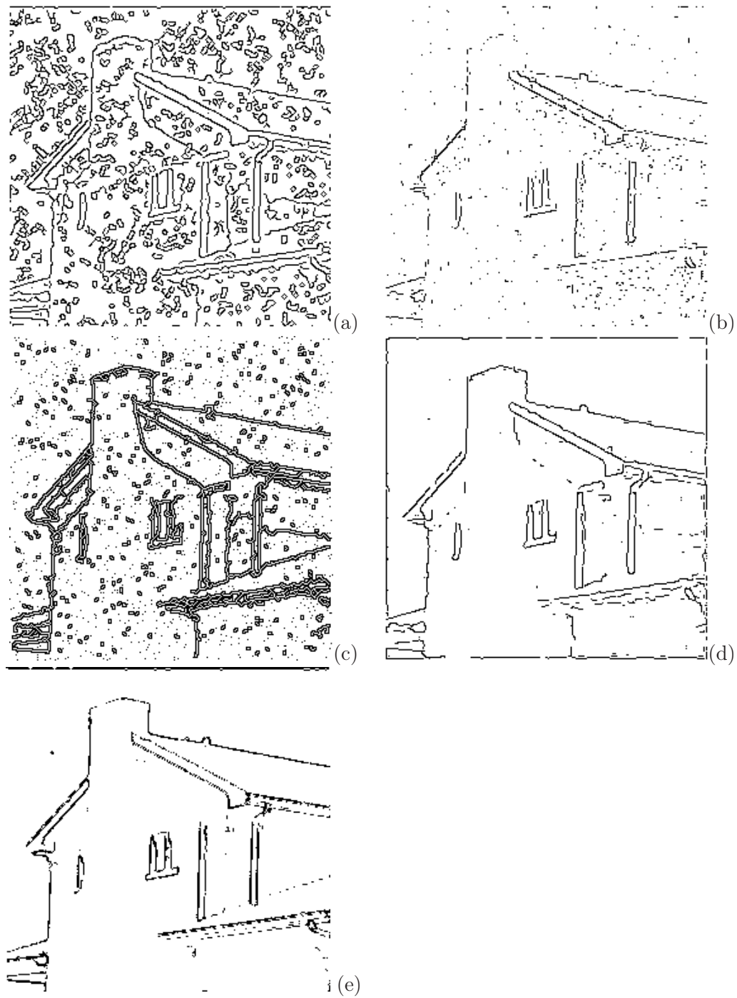
FIG. 3.29: Cartes de contours de l'image Maison bruitée avec un bruit impulsionnel de 5% par les algorithmes : (a) Canny ( \sigma = 1.50 , t_b = 0.30 et t_h = 0.80 ), (b) Shen et Castan ( \gamma = 1 , t_b = 30 et t_h = 60 ), (c) SUSAN ( BT=20 et DT=4 ), (d) Deriche ( \tau = 1 , t_b = 10 et t_h = 50 ), (e) Proposé ( \alpha = 30 , \omega = 5 et \beta = 1 ).
