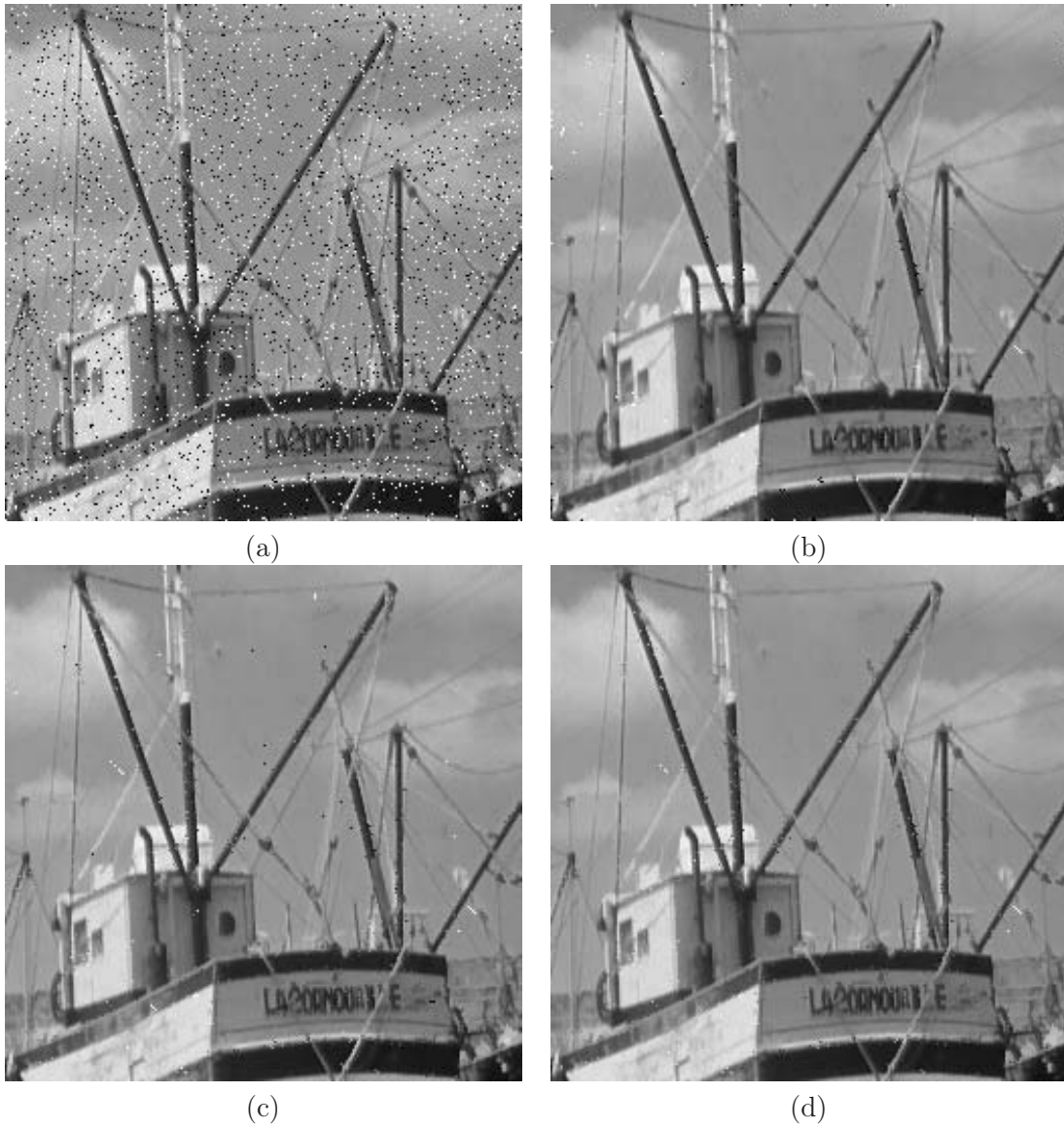
FIG. 2.20: Comparaison avec le filtre médian multiétage. (a) image bateau (bruit impulsif 5 %), (b) Image de sortie de l'algorithme (représentation B), Images filtrées par MLMF avec une taille de fenêtre de : (c) 5 \times 5 , (d) 7 \times 7 .
