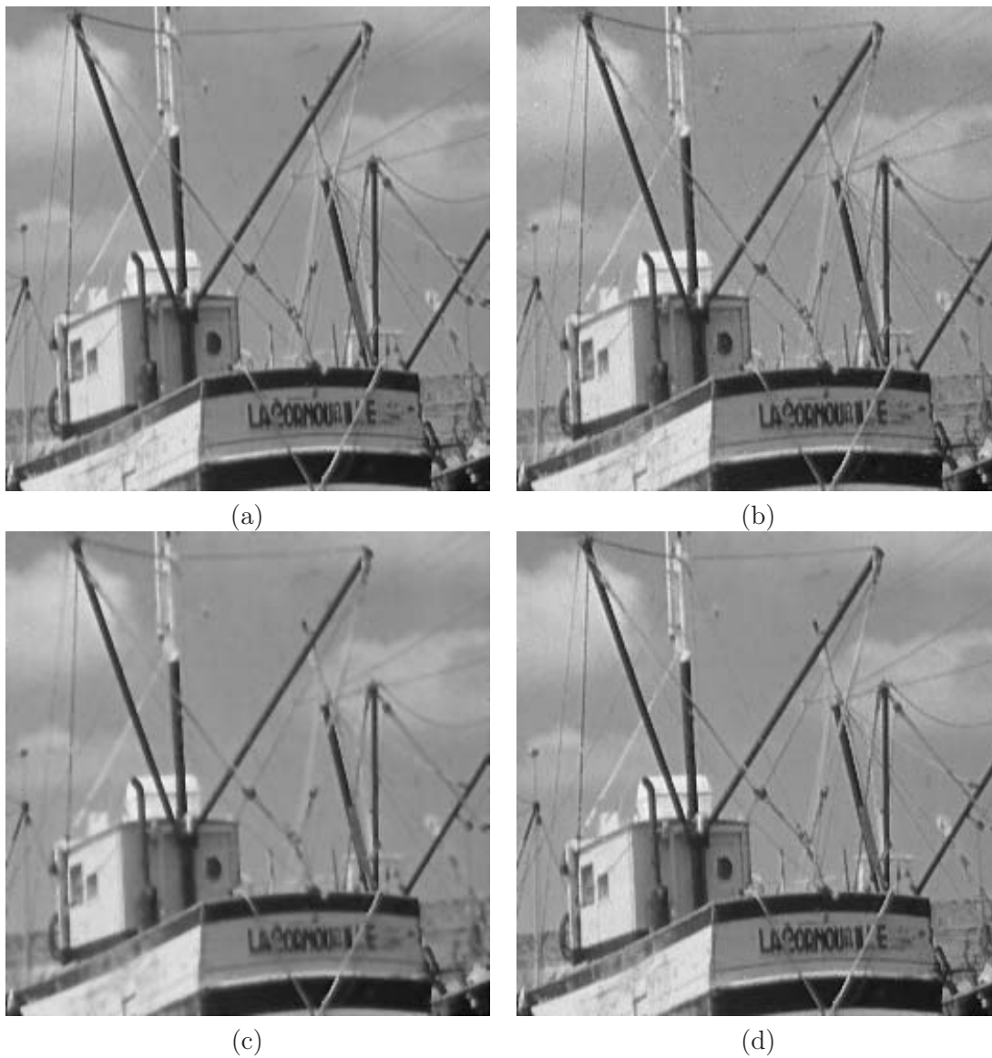
FIG. 2.22: Comparaison avec le filtre de Wiener (bruit gaussien additif \sigma = 15 , 5%). (a) l'image originale, (b) l'image bruitée, (c) l'image de sortie du filtre de Wiener. (d) l'image filtrée par l'algorithme (représentation B).
