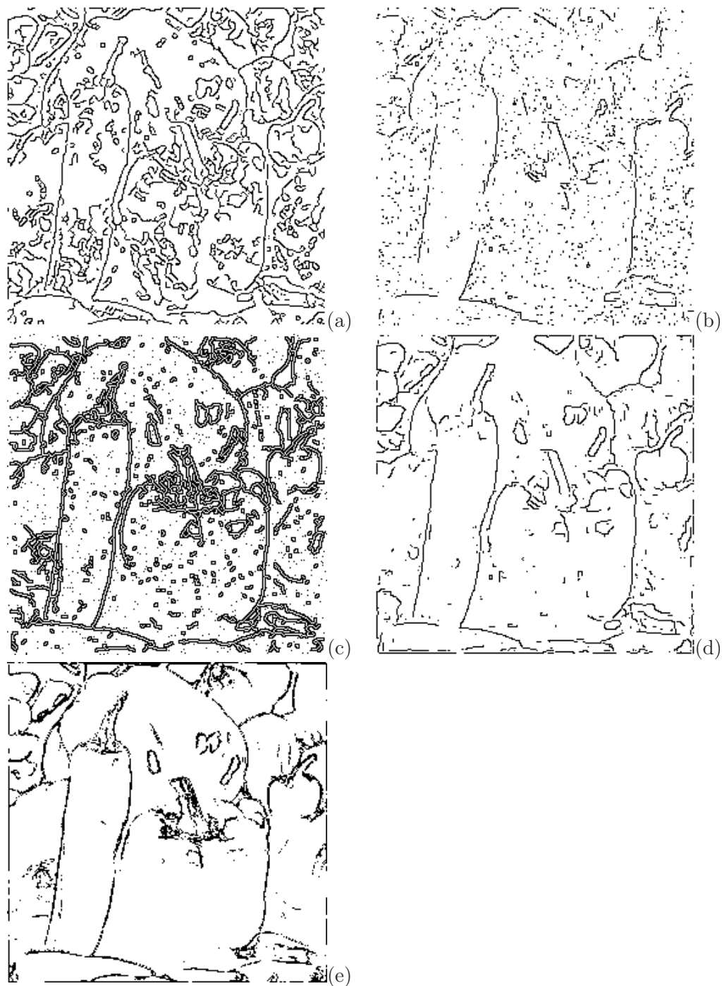
FIG. 3.30: Cartes de contours de l'image Poivron bruitée avec un bruit impulsionnel de 5% par les algorithmes : (a) Canny ( \sigma = 1.50 , t_b = 0.30 et t_h = 0.60 ), (b) Shen et Castan ( \gamma = 1 , t_b = 25 et t_h = 60 ), (c) SUSAN ( BT=20 et DT=4 ), (d) Deriche ( \tau = 1 , t_b = 8 et t_h = 45 ), (e) Proposé ( \alpha = 25 , \omega = 5 et \beta = 1 ).
