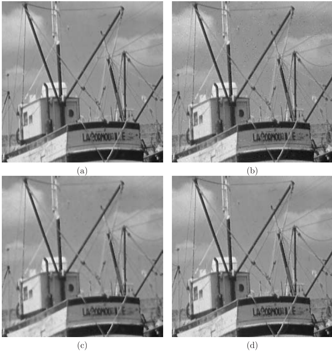
FIG. 2.23: Comparaison avec le filtre de Wiener (bruit gaussien additif \sigma = 20 , 5%). (a) l'image originale, (b) l'image bruitée, (c) image de sortie du filtre de Wiener. (d) l'image filtrée par l'algorithme (représentation B).
